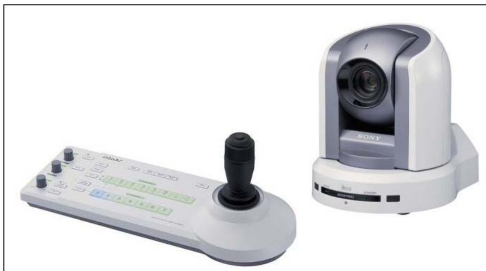
KUVA 5: RM-BR300 kauko-ohjain ja BRC-300 robottikamera (Videobotics & blogmaster.fr)
