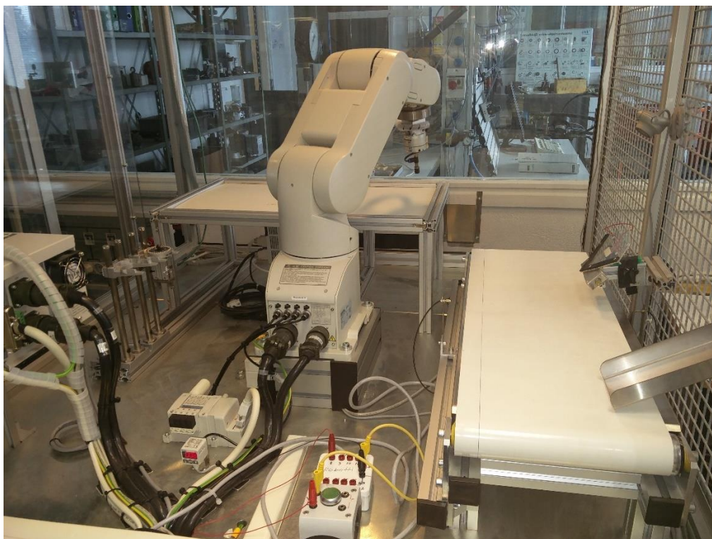
KUVA 1. Mitsubishi RV-2AJ -robottikäsi sekä robottisolu (Liimatainen 2016.)
