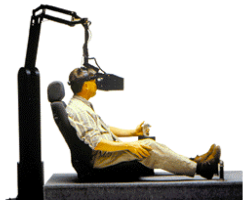
KUVA 6. Kaksi erilaista BOOMia. Jälkimmäinen jättää käyttäjän kätet vapaiksi (Hamish 2005).
