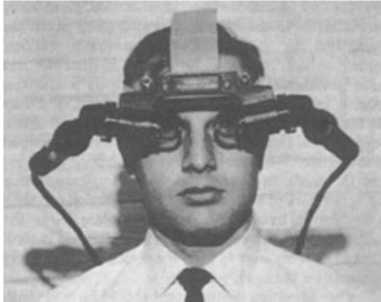
KUVA 4. Sutherlandin Head-Mounted Display koostui kahdesta CRT-näytöstä (Carlson 2003).
