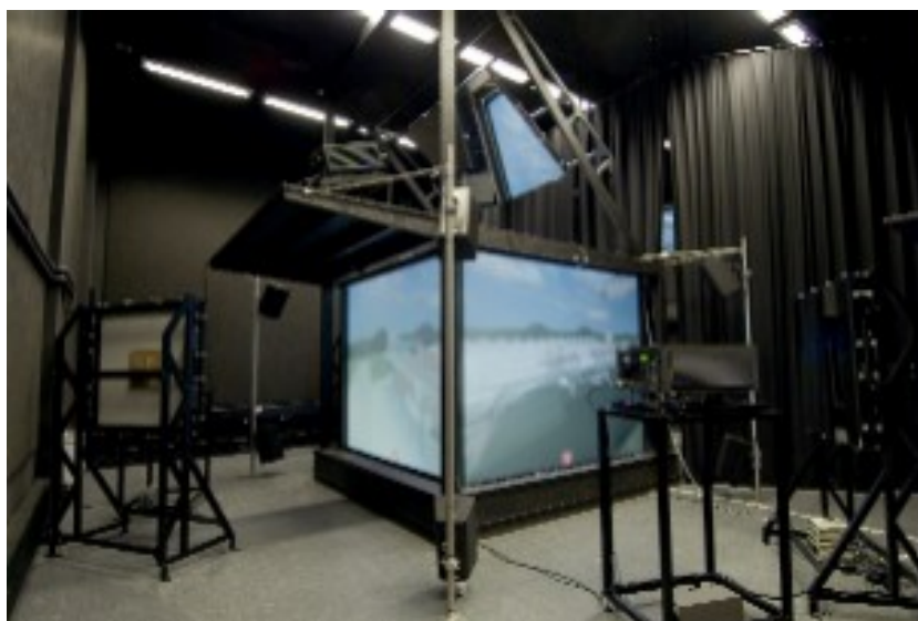
KUVA 8. Seinäjoen ammattikorkeakoulun viiden seinän CAVE. Projektorit ja
