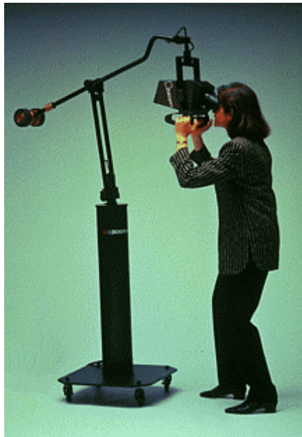
KUVA 6. Kaksi erilaista BOOMia. Jälkimmäinen jättää käyttäjän kätet vapaiksi (Hamish 2005).
