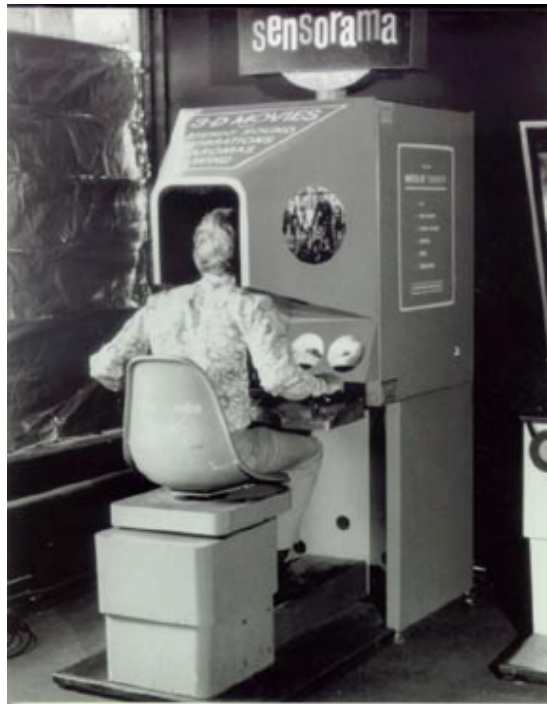
KUVA 3. Sensorama oli ensimmäinen laite, jossa päästiin lähelle keinotekoista virtuaalista elämystä (Carlson 2003).
