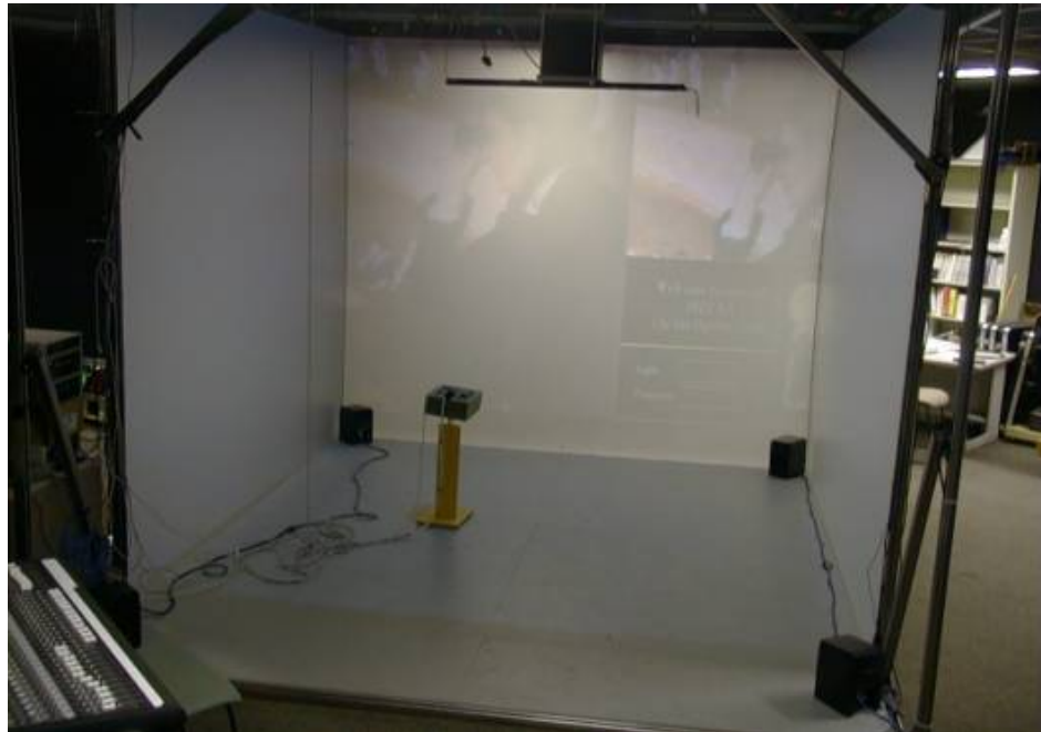
KUVA 7. CAVE rakentuu kolmesta seinästä, äänilaitteistosta, projektoreista sekä tehokkaista grafiikkatyöasemista (NCSA 2004).
