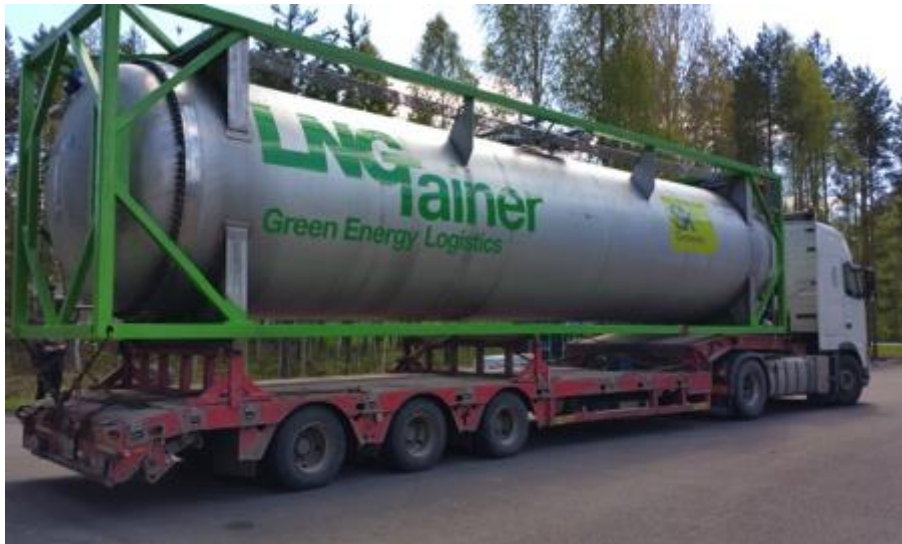
Kuvio 2. LNG-kuljetuskontin prototyyppi.
