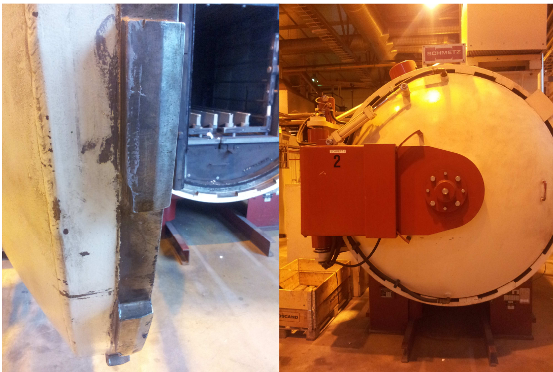
Kuva 5. Schmetz pinnoitusuunin luukku ja kehän hammastus. (Alm 2015)
