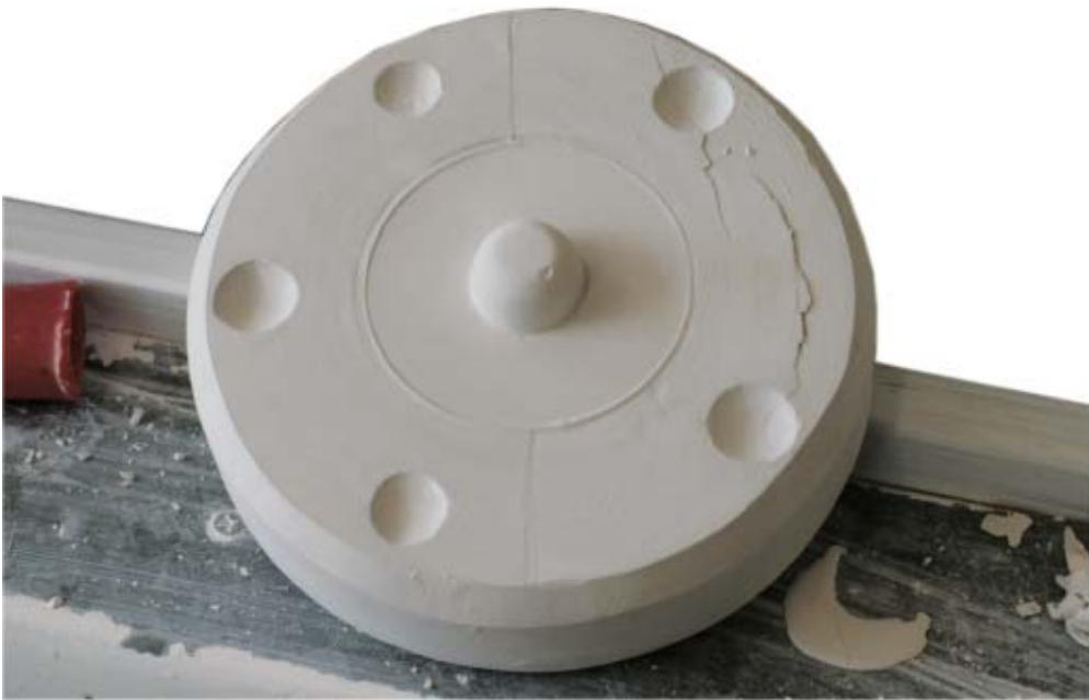
Kynttilänjalan muotissa ongelmakohtana oli sisämuoto, joka katkesi useita kertoja.
