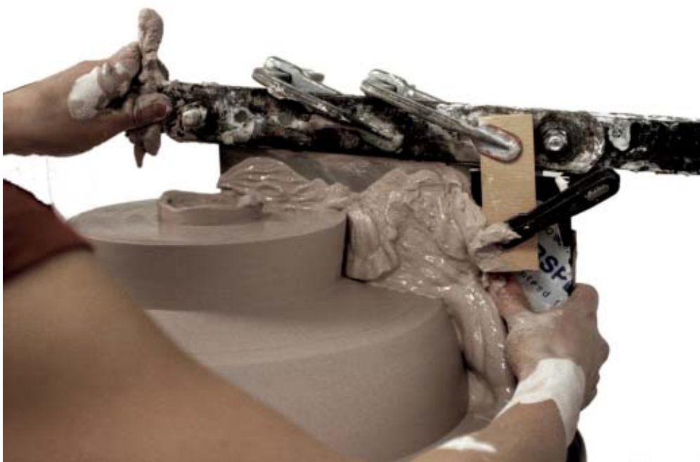
Riikka Ahonen valmisti mallineet kipsidreijalla, materiaalina kovakipsi.
