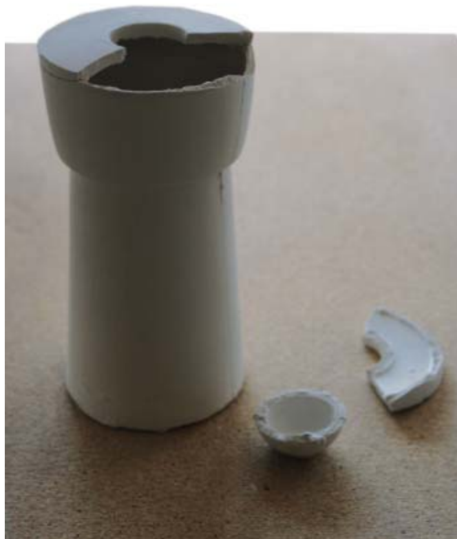
Ensimmäinen kynttilänjalka jäi sisäosastaan muottiin kiinni ja repesi.
