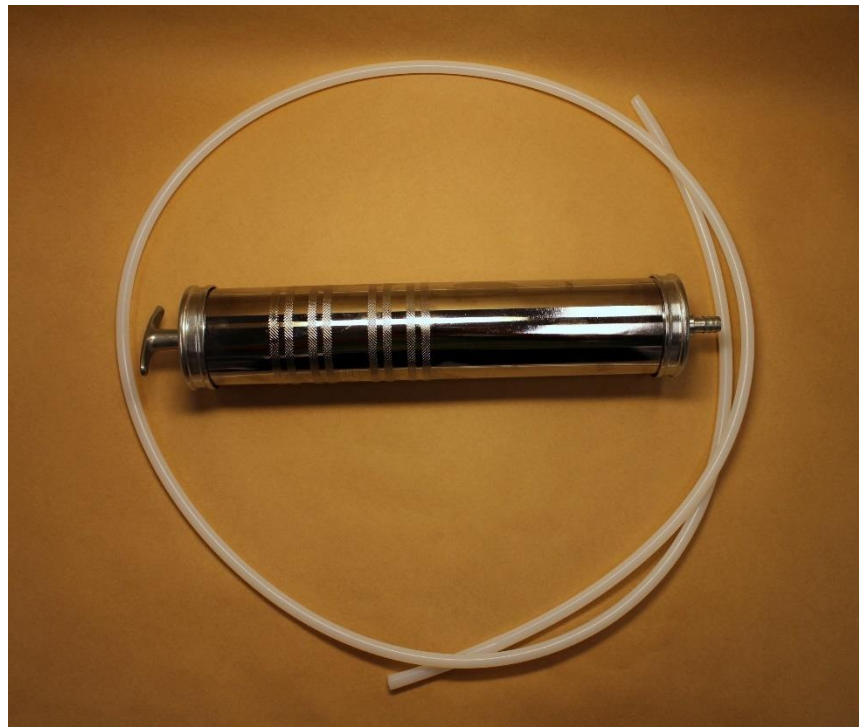
Kuva 12. Mikäli putkinoutimen käyttö ei ole mahdollista, voidaan ruiskun ja letkun avulla imeä säiliöstä nestettä näytteeksi.
