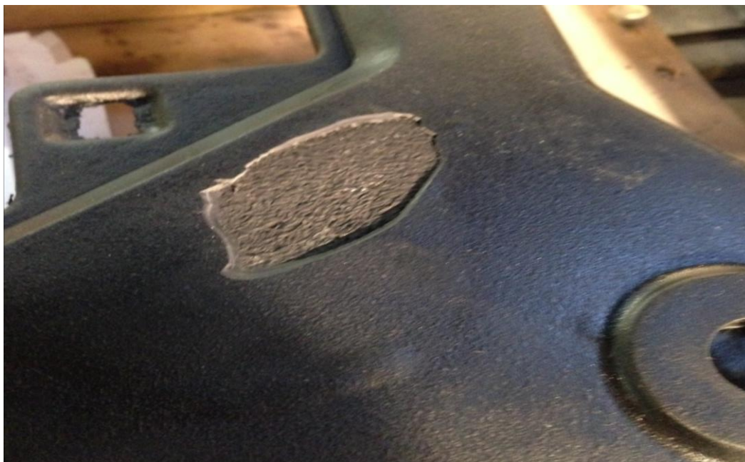
KUVA 6. VAHAN PUUTTUMISEN TAKIA POLYURETAANITUOTTEEN PINTANAHKA ON JÄÄNYT MUOTTIIN KIINNI.
