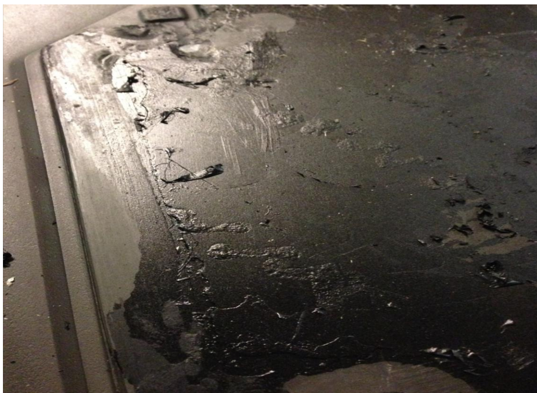
KUVA 3. LÄHIKUVAA VANHASTA HUONOSTA IRROTUSVAHASTA.
