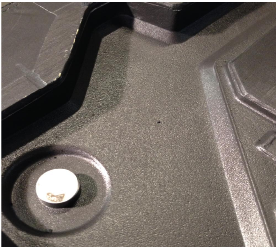
KUVA 5. MUOTIN PINTA VAHAUKSEN JÄLKEEN.
