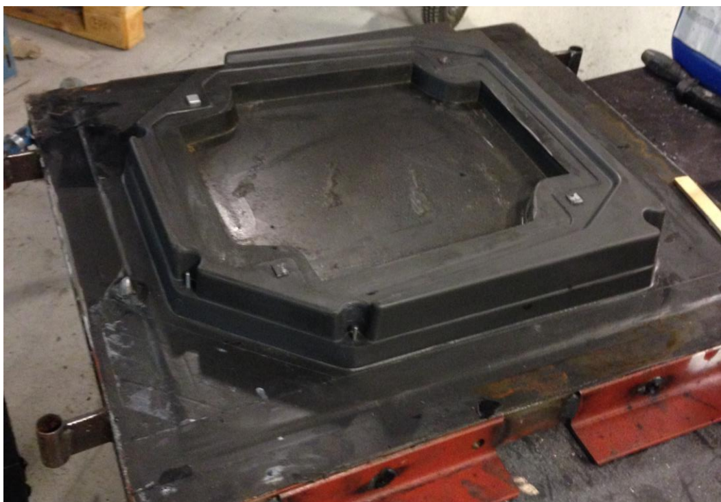
KUVA 1. KÄYTETTY MUOTTI ENNEN VANHAN VAHAN POISTAMISTA.
