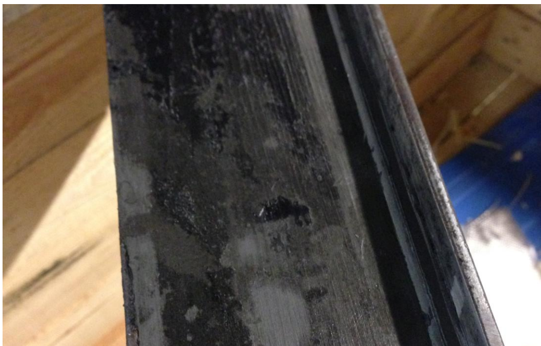
KUVA 4. MUOTIN PINTAAN TARTTUNUT VAHA TEKEE VALMISTETTAVAN KAPPALEEN PINNASTA HUONOLAATUISEN.
