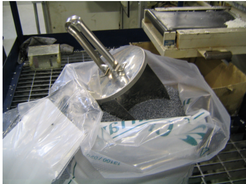
Kuvio 1: Väriainepussi ja väriaineen siirtoon tarkoitettu kauha
