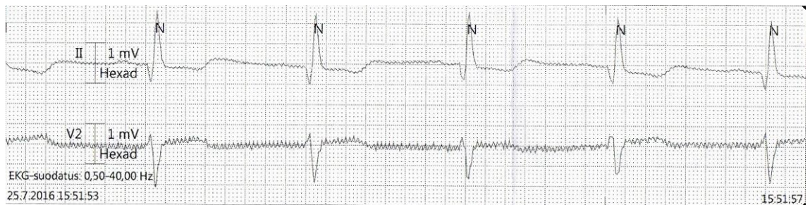
KUVA 6. Vaihtovirtahäiriö (Kuva: Mika Huuhtanen 2016)
