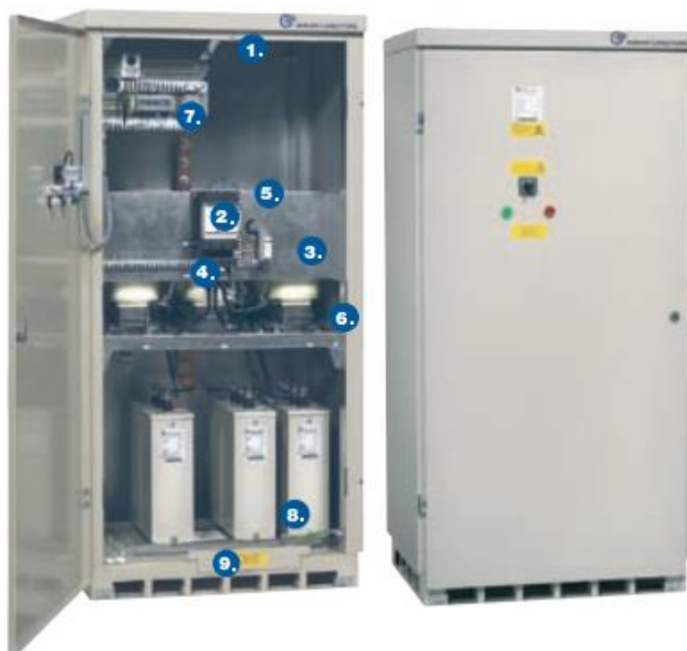
KUVA 8. Kolmannen yliaallon suodatin. 1. Tuuletin 2. Kontaktori 3. Jännitteen valvontarele 4. Ylivirtarele 5. Kaapeliliitäntä 6. Kuristimet 7. Ohjauskaapelien riviliittimet 8. Kondensaattoriyksiköt 9. Ilmansuodatin (Nokian Capacitors 2016.)
