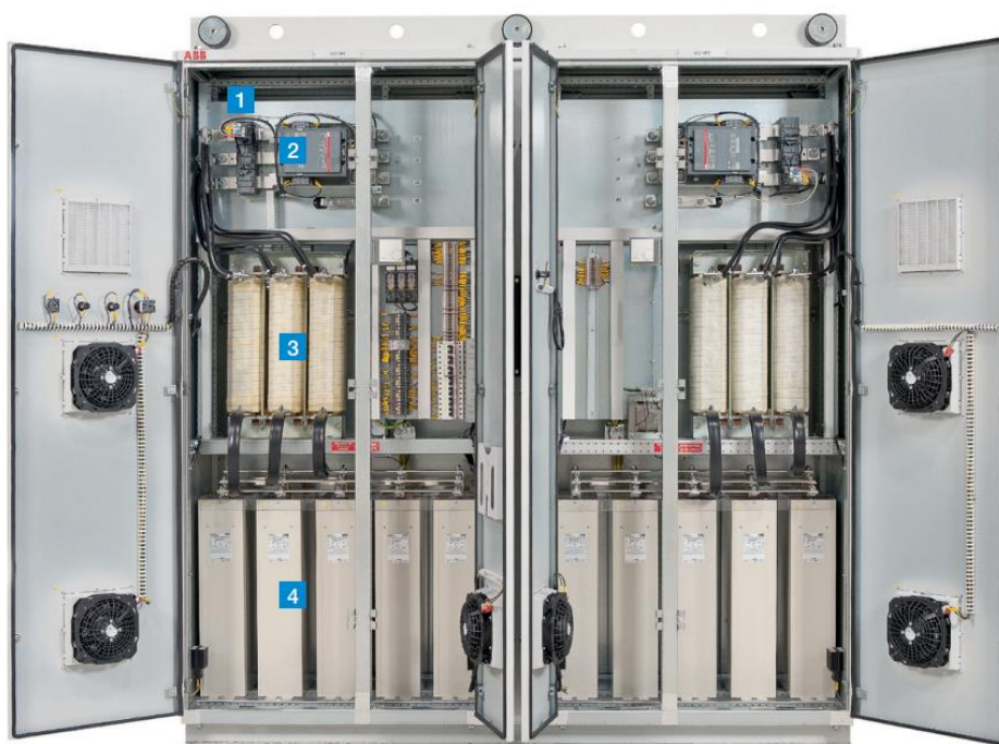
KUVA 6. Yliaaltosuodatin. 1. Lämpörele 2. Kontaktori 3. Kela 4. Kondensaattorit (ABB Oy 2016.)
