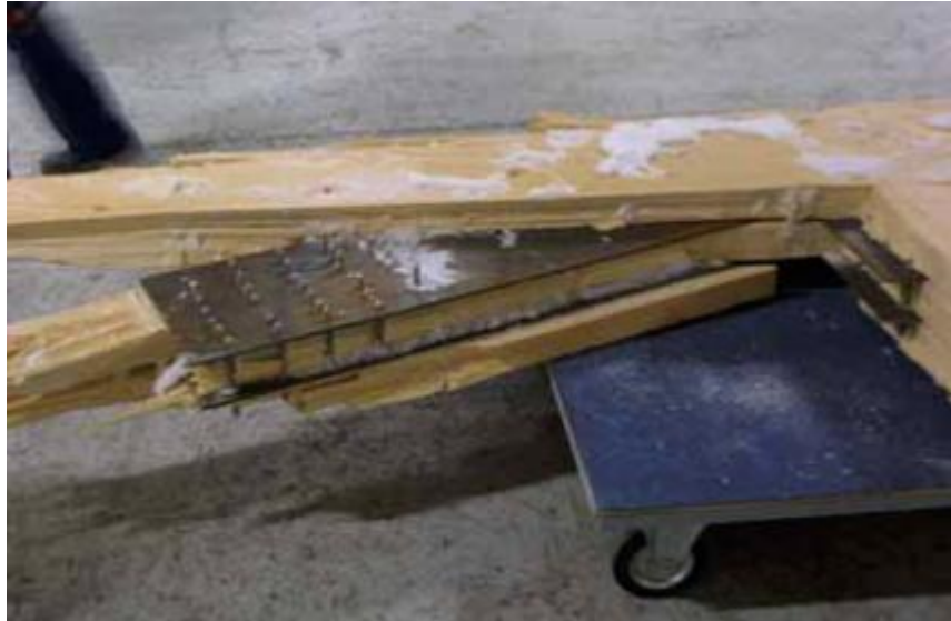
KUVIO 19. Vaarnatappiliitoksen murtuminen Jyväskylän messuhallissa (Onnettomuustutkintakeskus 2003.)
