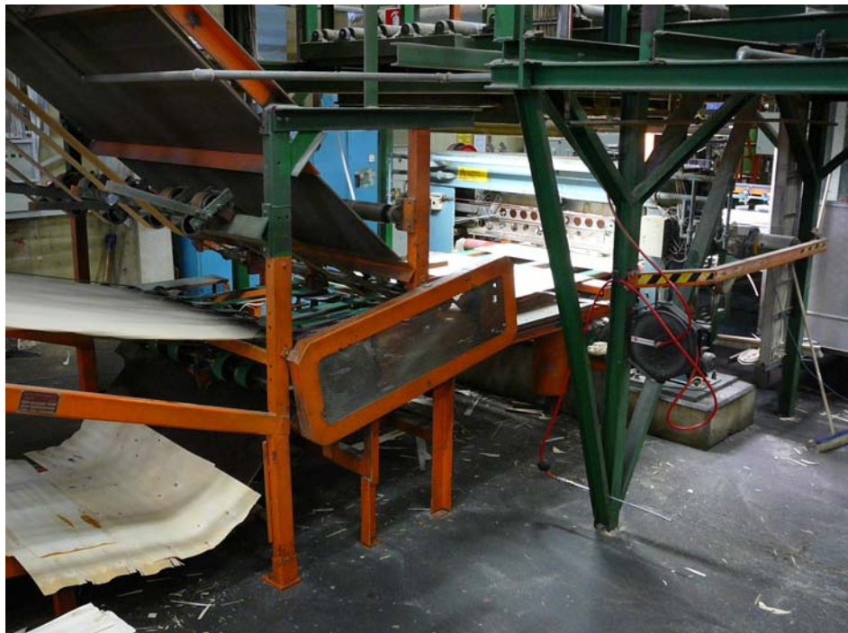
KUVIO 11. Leikkurin jälkeen roskat ohjautuvat ylös ja viilut kuormauspaikoille
