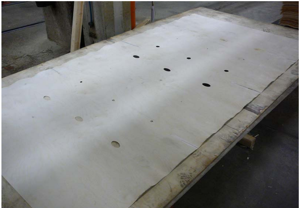
KUVIO 42. Kokeessa käytetty viilumatto (virheet tehtiin kolmeen riviin)
