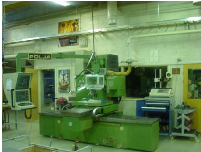
Kuva 6. Valumallinvalmistuksen työsalin CNC -jyrsin.
