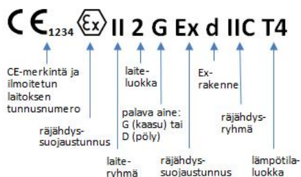
Kuva 3. Esimerkki sähkölaitteen laitemerkinnästä (Lisätietoa ATEX-laitedirektiivistä 2016).
