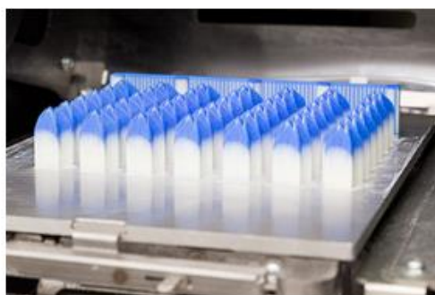
Lumikukat ovat nyt nupullaan siniseen vahaan tietokonemallin mukaan tulostettuina.
