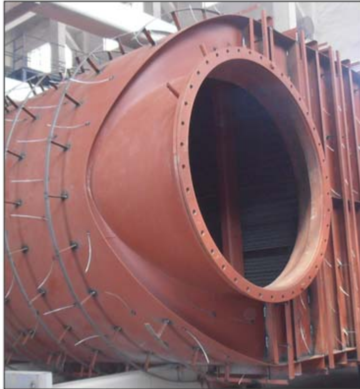
Kuva 28. Esimerkki AV-6N kattilan eristysraudoituksesta
