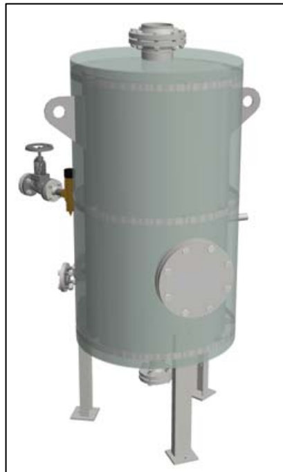
Kuva 6. Mallinnus tyypillisestä ulospuhallustankista (Alfa Laval Aalborgin sisäinen tietokanta 2015)
