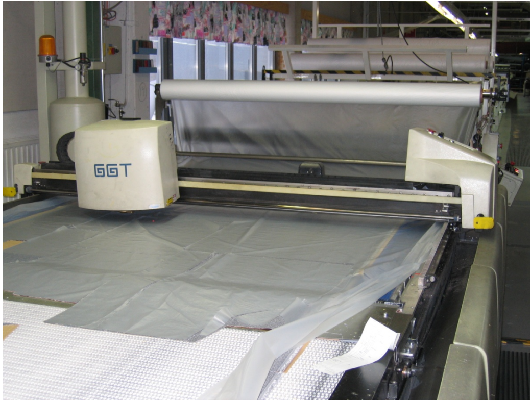
KUVIO 4 Gerber S-3000 -automaattileikkuri leikkaamassa laakaa
