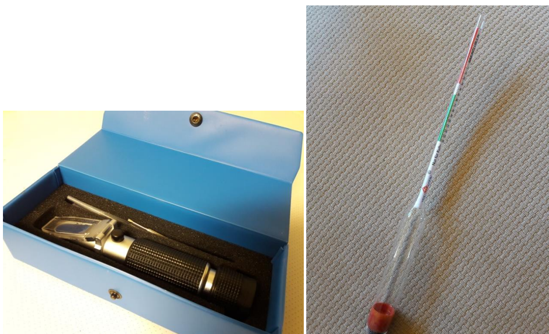
KUVA 2. Ternimaidon laatua voidaan mitata refraktometrillä (vas.) tai kolostrometrillä (oik.). Ternimaidon laatu on yksi merkittävimmistä vasikan vastustuskykyyn vaikuttavista tekijöistä (Sirviö 2016).
