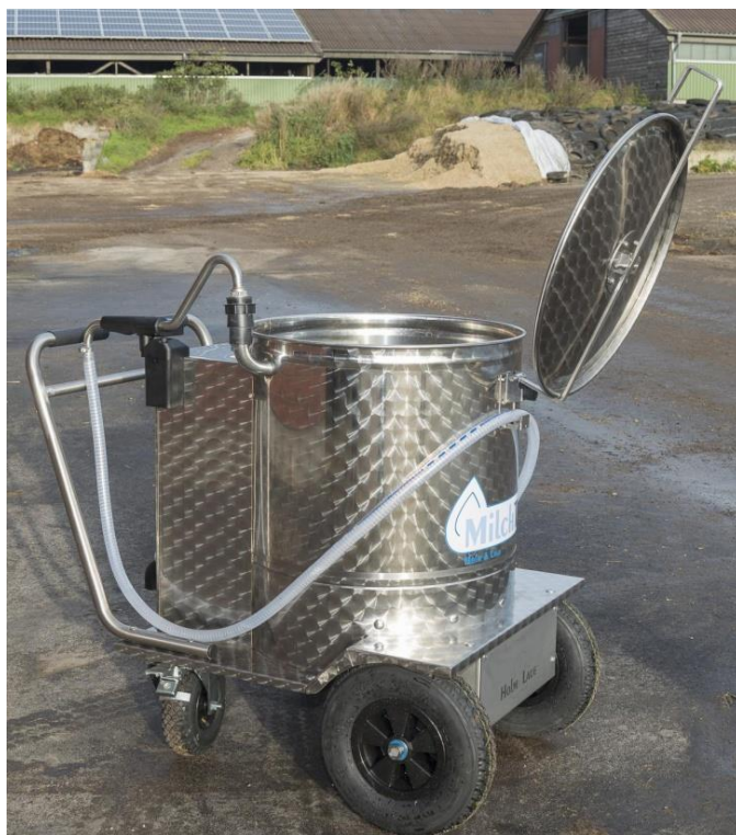
KUVA 20. Juottovaunun avulla vasikoiden juottotapahtuma pysyy mahdollisimman tasaisena juottokerrasta toiseen. Lisäksi se keventää hoitajan työtä ( http://www.holmlaue.de/bildergalerie.php?id=mtx&id2=1 ).
