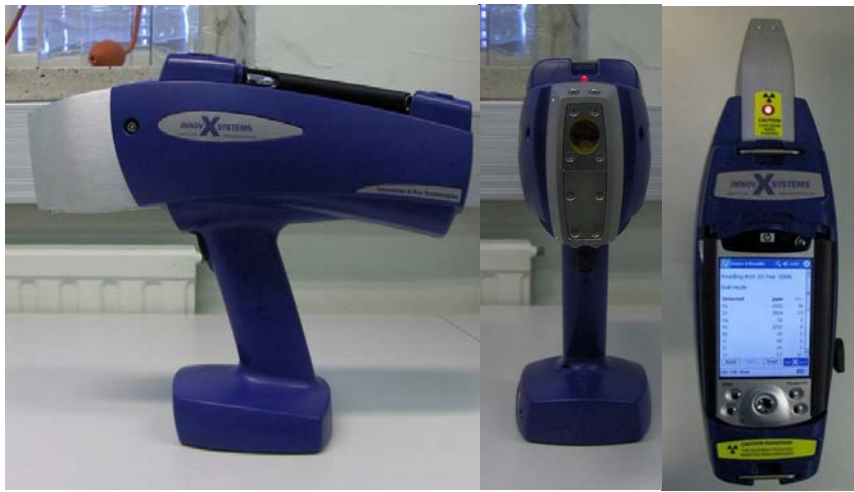
KUVIO 2. Tutkimuksissa käytettiin Innov-X Systemsin XRF-kenttälaitetta.
