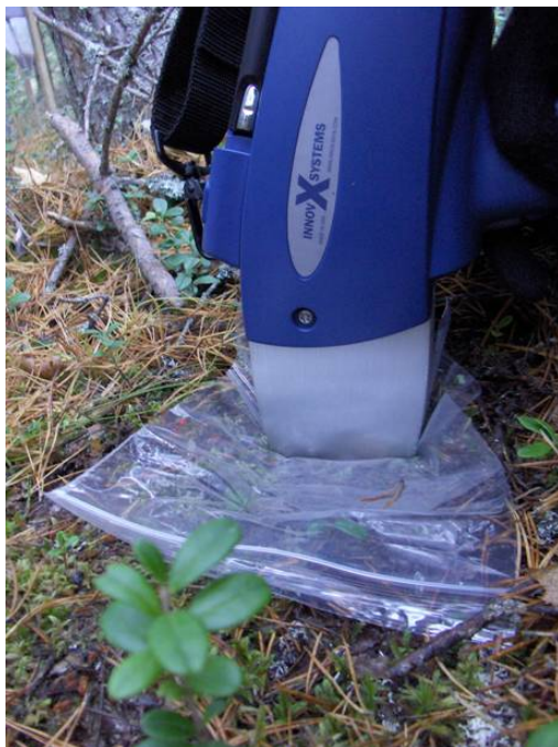
KUVIO 4. XRF-kenttälaitte mittaamassa näytekohtaa suoraan maasta.
