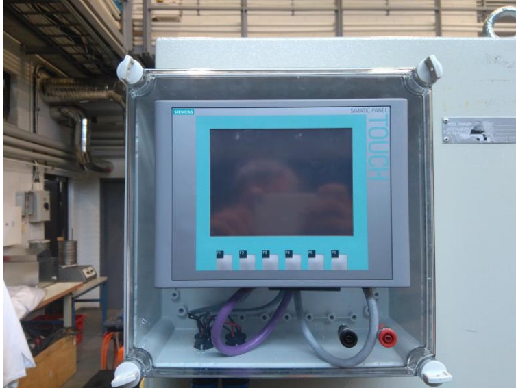
KUVA 11 Siemens KTP600-HMI (Valokuva Iiro Nevalainen)
