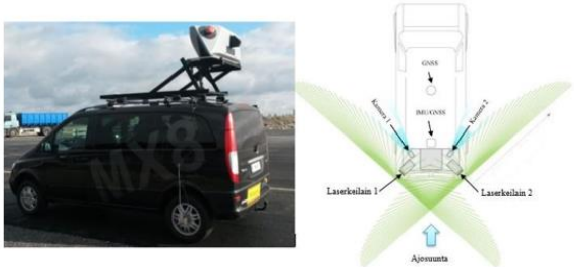
Kuva 8. Vasemmalla Trimble MX8 -mobiilikartoitusjärjestelmä asennettuna pakettiautoon. Oikealla tyypillinen esimerkki mobiililaserkeilausjärjestelmän koostumuksesta. [2; 9.]
