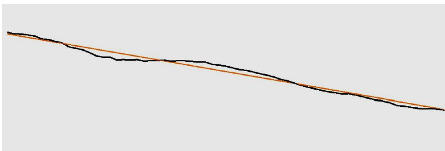
Kuva 2. Sovitettu kaltevuus. Kaltevuusviiva sovitetaan vasemmanpuoleisen ja oikeanpuoleisen kaistan mukaan. Kaikki pisteet suljetaan pois laskennasta, jotka eivät ole annettujen toleranssien sisäpuolella.
