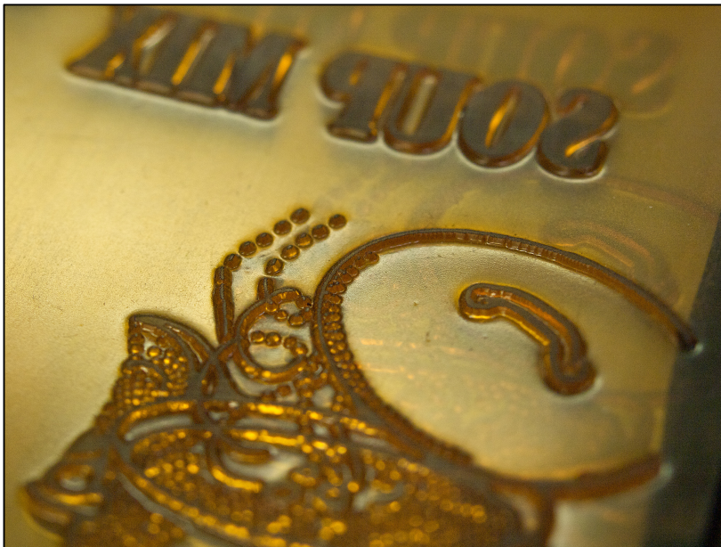
KUVA 3 Fleksopainolaatassa painoaihe on koholla ja peilikuvana. ©Dale Simonson
