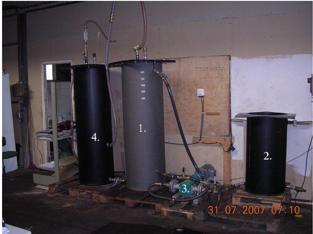
KUVIO 2. Watrec pilot -biokaasulaitteisto: 1.biokaasureaktori, 2. syöttösäiliö, 3. syöttö- / sekoituspumppu ja 4. vesilukko
