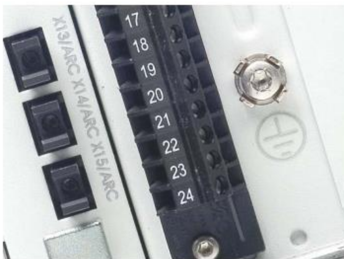
Kuva 5. REF615 suojareleen valokaarisuojauksen liitännät (ABB 2010)
