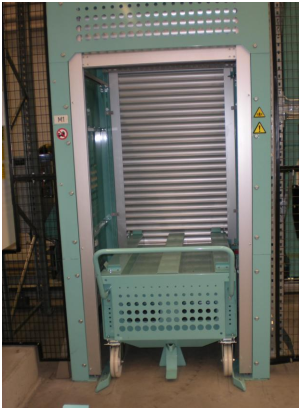
Kuva 7. Kuvassa materiaalin lataus asema, jossa on liikuteltava lavakärry
