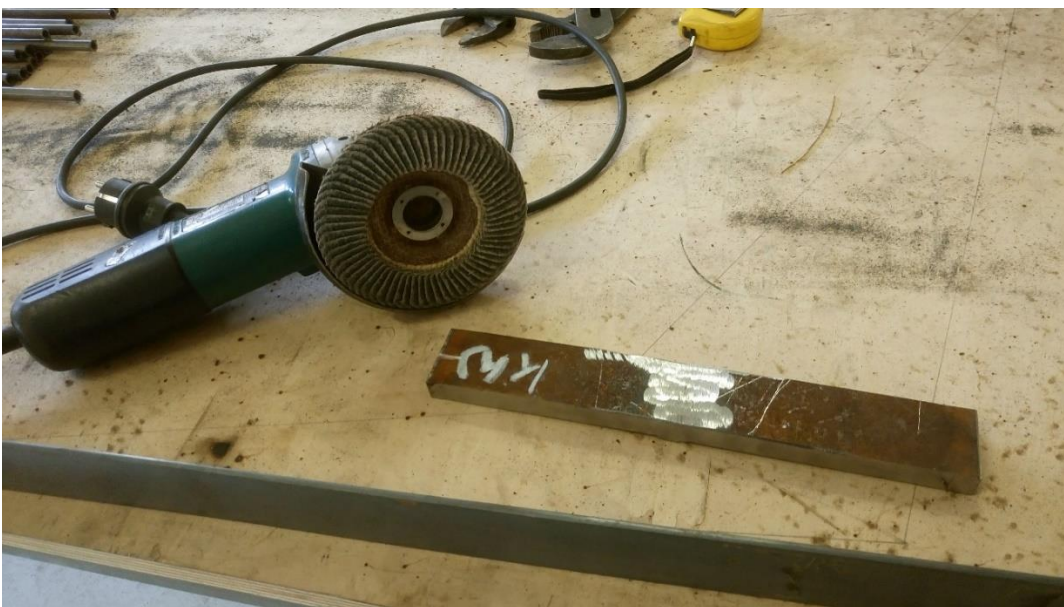
KUVA 5. Kulmahiomakoneella hiottu hitsin kupu pinnalle
