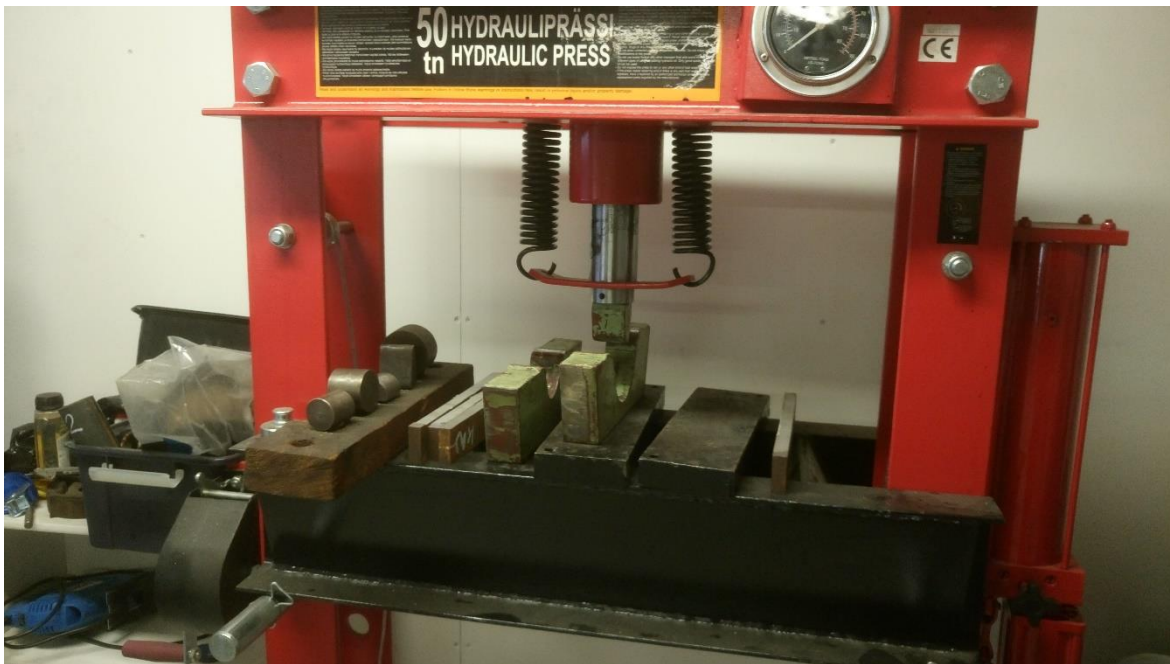
KUVA 6. Hydrauliprässi ja koekappaleiden taivutuspenkki
