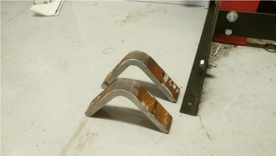
KUVA 7. Taivutetut hitsauksen juuri- ja pintakoekappaleet
