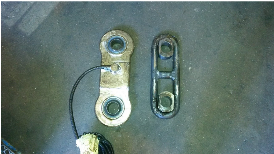
Kuva 16. Punnitusanturi ja tarttujan riipuke.
