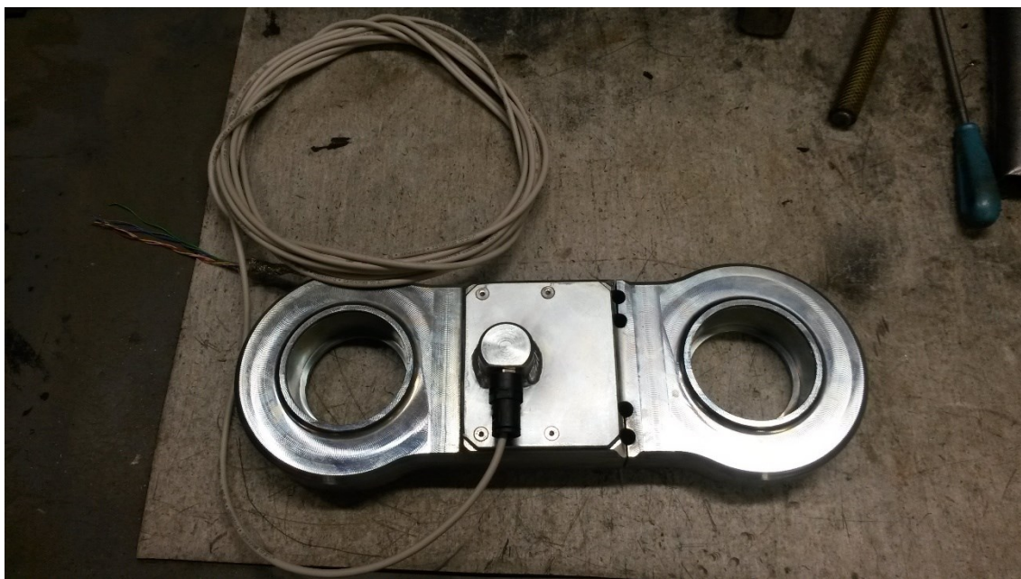
Kuva 12. Poskilevyyn kiinnitetty läpivientiholkki.
