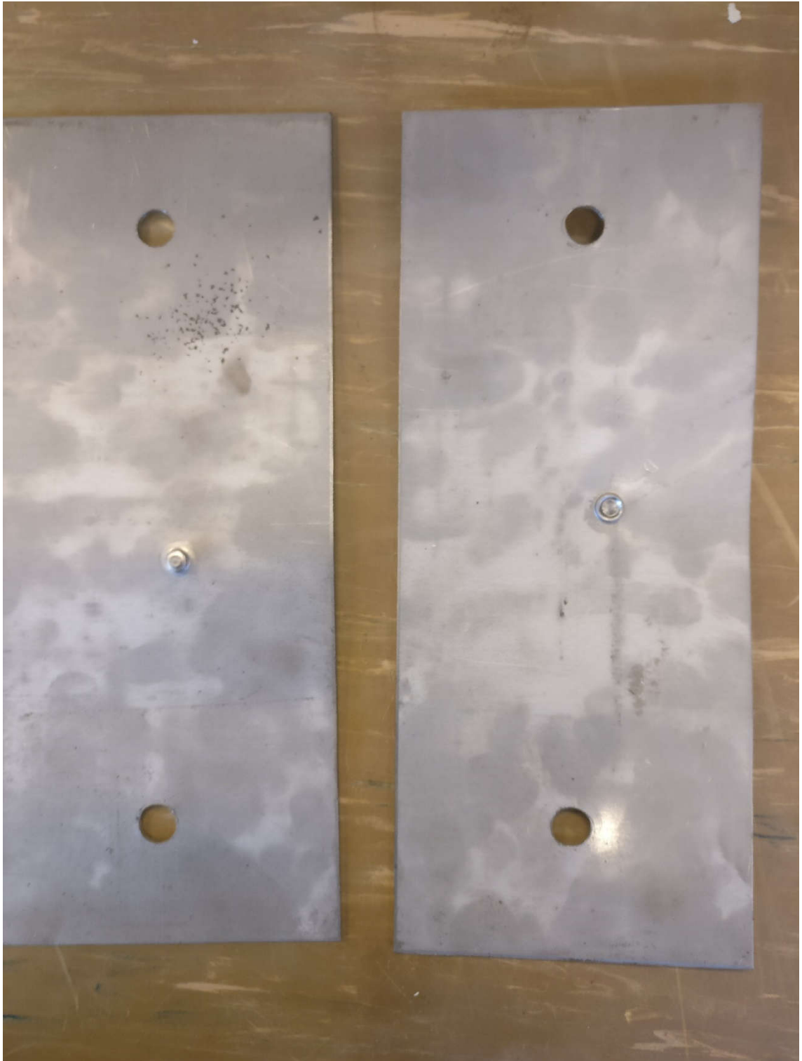
Kuva 21. Ristivetokokeen koekappale vetokokeen jälkeen.
