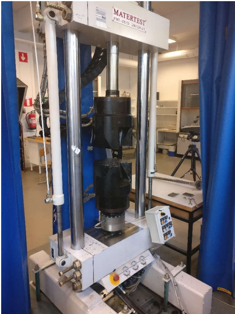
Kuva 7. Materters FMT – vetokone.
