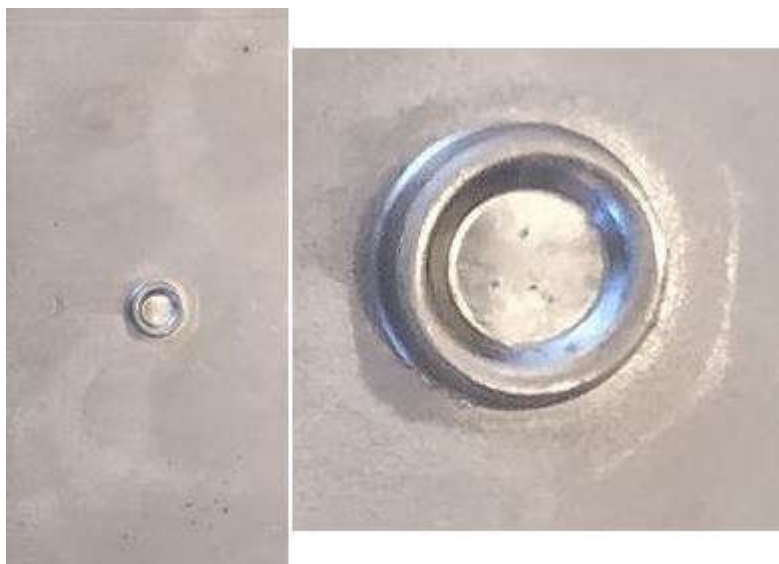
Kuva 19. Tox-liitos 203 Bar voimalla, materiaali EN 1.4003, materiaalinpaksuus 2 mm.
