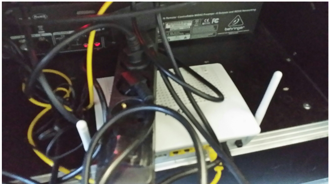
KUVIO 26. Reititin mikseriin kytkettynä ja kiinnitettynä räkkiin
