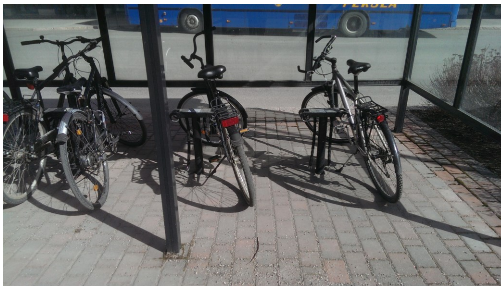
Kuva 8 Linja-autoaseman viereisessä pyöräpysäköinnissä käytetään runkolukittavia tolppatelineitä (Kuva Henri Luoto 2016).
