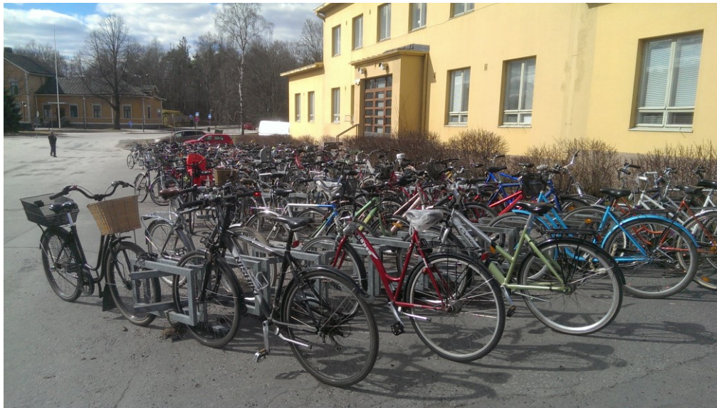
Kuva 13 Pyöräpysäköinti, jossa käytetään vannetelineitä, vaatii paljon tilaa alueelta (Kuva Henri Luoto 2016).
