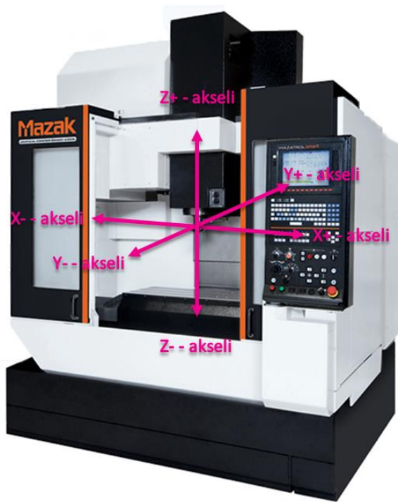
KUVA 6 Mazak Smart 430A pystykarainen koneistuskeskus ja koordinaattiakselit (Mazak , 2016)
