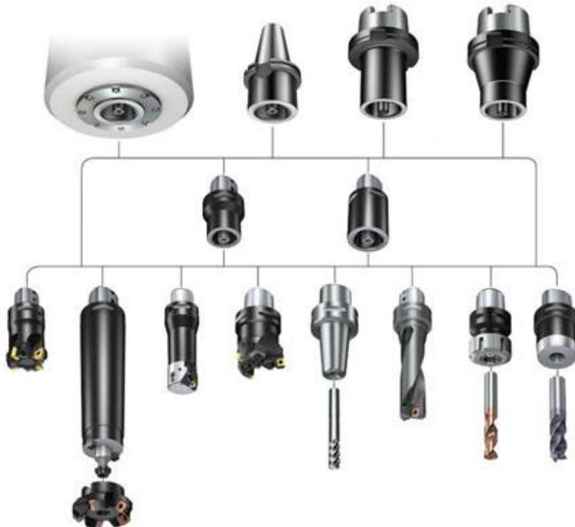
KUVA 7 Sandvik Capto modulaarinen työkalujärjestelmä koneistuskeskukselle (Sandvik Coromant, 2016)
