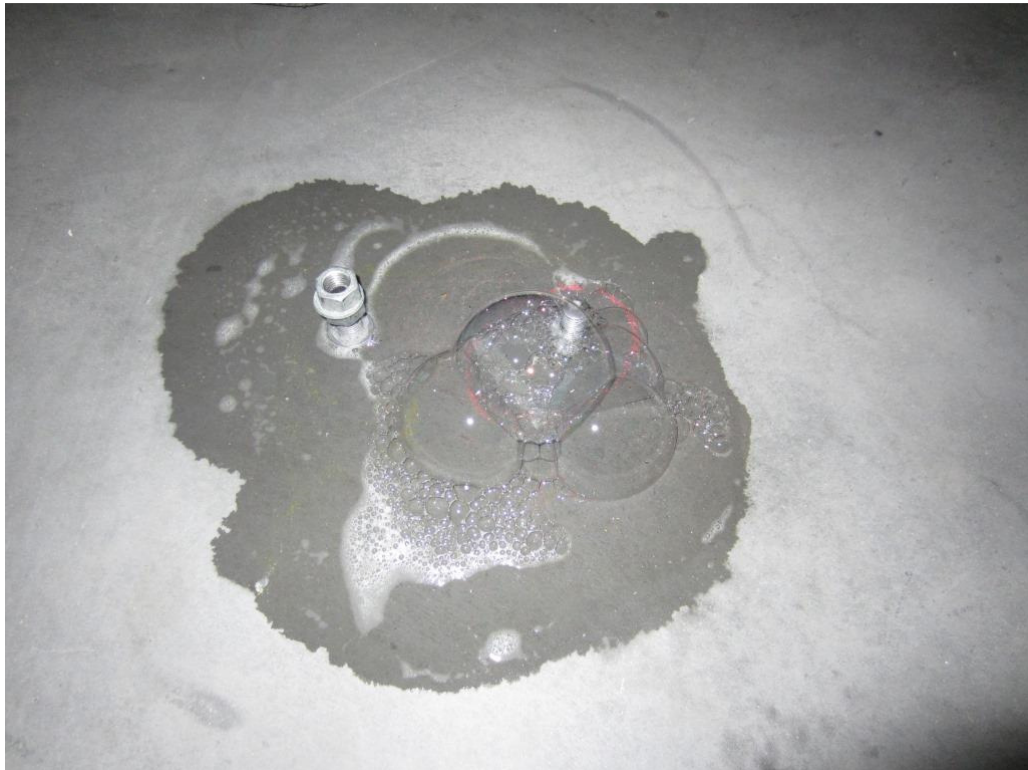
Kuva 60. Saippuavesi kuplii pultin juuresta vuotokohtaa paikantaessa.
