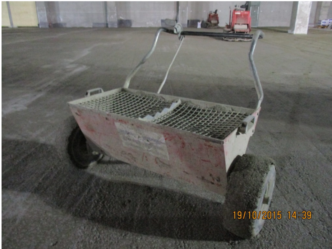
Kuva 22. Kuivasirotteen levitykseen tarkoitettu sirotekärry.
