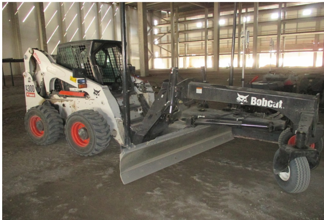
Kuva 8. Primekss käyttää lanalla varustettua Bobcat-konetta maan levittämiseen.
