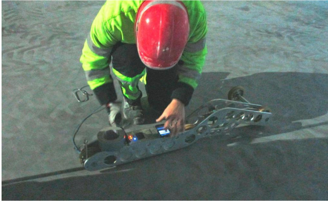
Kuva 16. "Koiraksi" kutsuttu mittauslaite. Kuvassa esiintyvä Primekssin vanhempi mittauslaite on noin kolme kertaa pidempi kuin uusi F-meter-mittauslaite.
