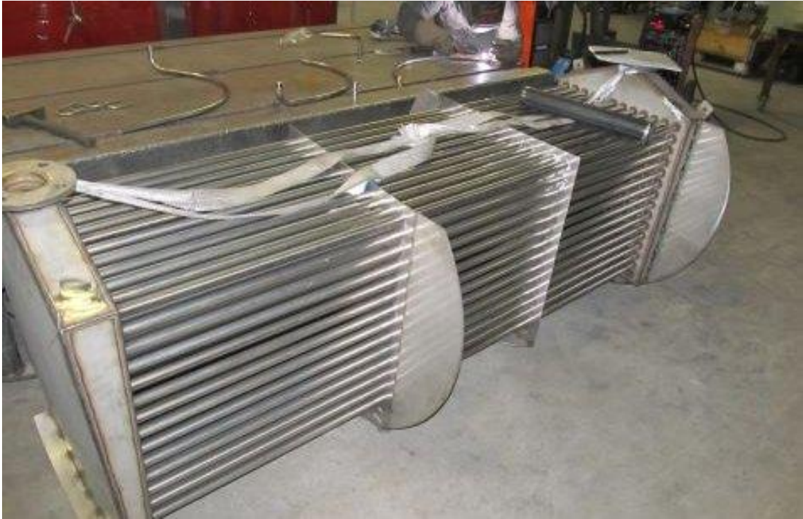
KUVA 6 Jätevesisäiliön sisällä oleva lämmöntalteenottoputkisto (6.)
