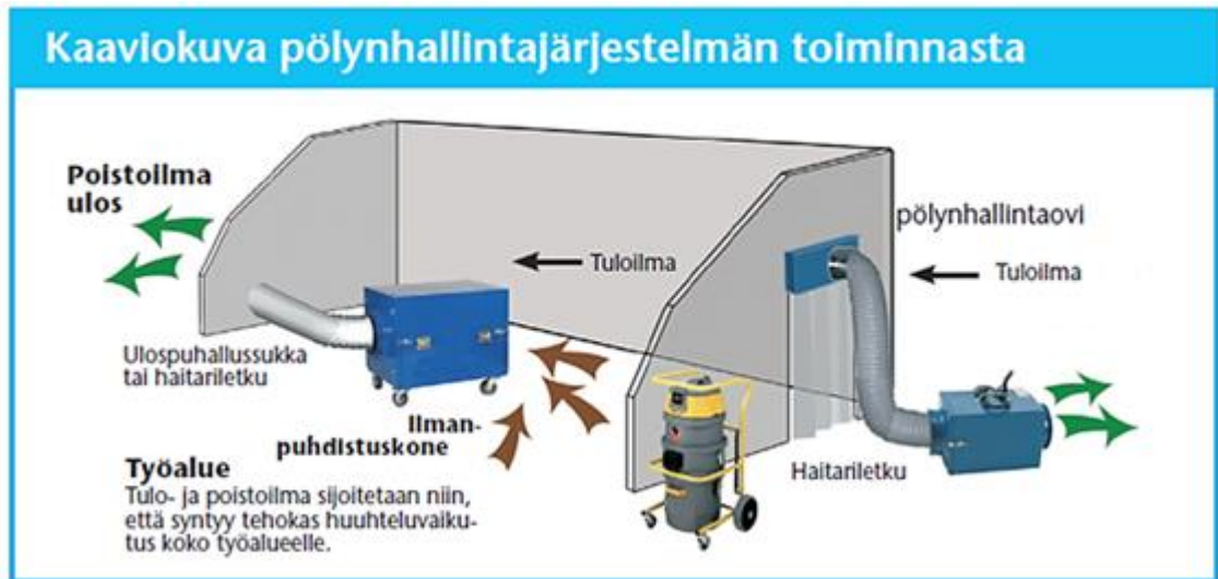
Kuva 6. Osastointimenetelmä työmaan pölyhallintaan
