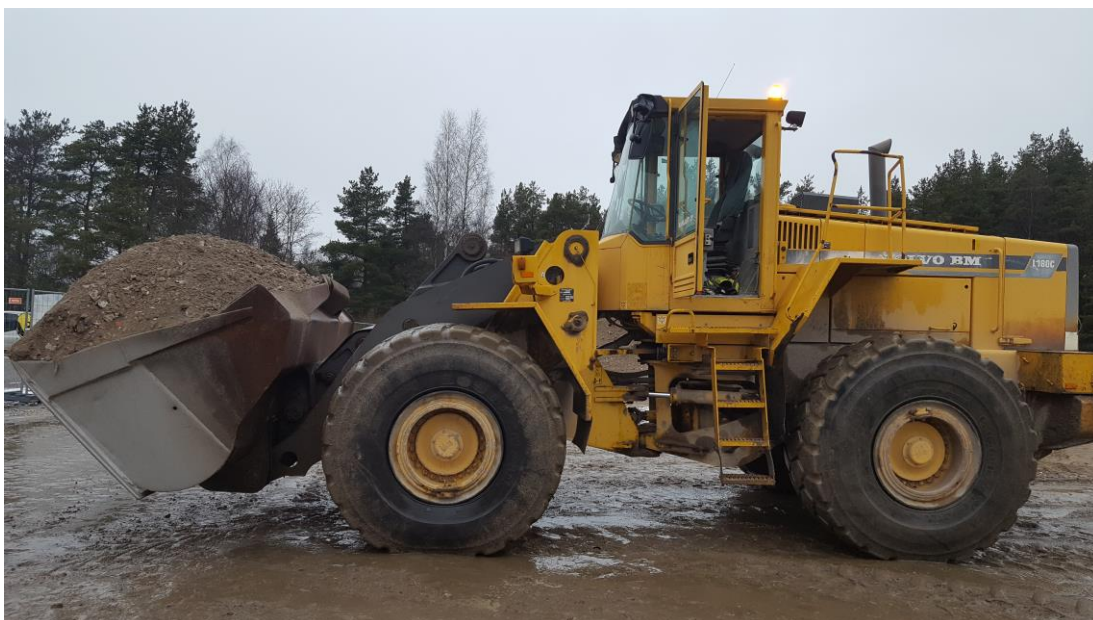
Kuva 10. Valmis betonimurske siirretään kuorma-autoihin, joilla ne kuljetetaan uusiokäyttökohteisiin.
