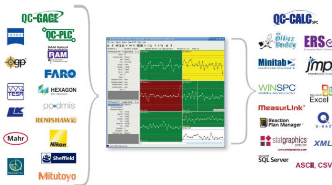
Kuva 15. QC-CALC Real-Time-ohjelman avulla mittaustiedot saadaan siirrettyä haluttuun ohjelmistoon (Prolink 2015).
