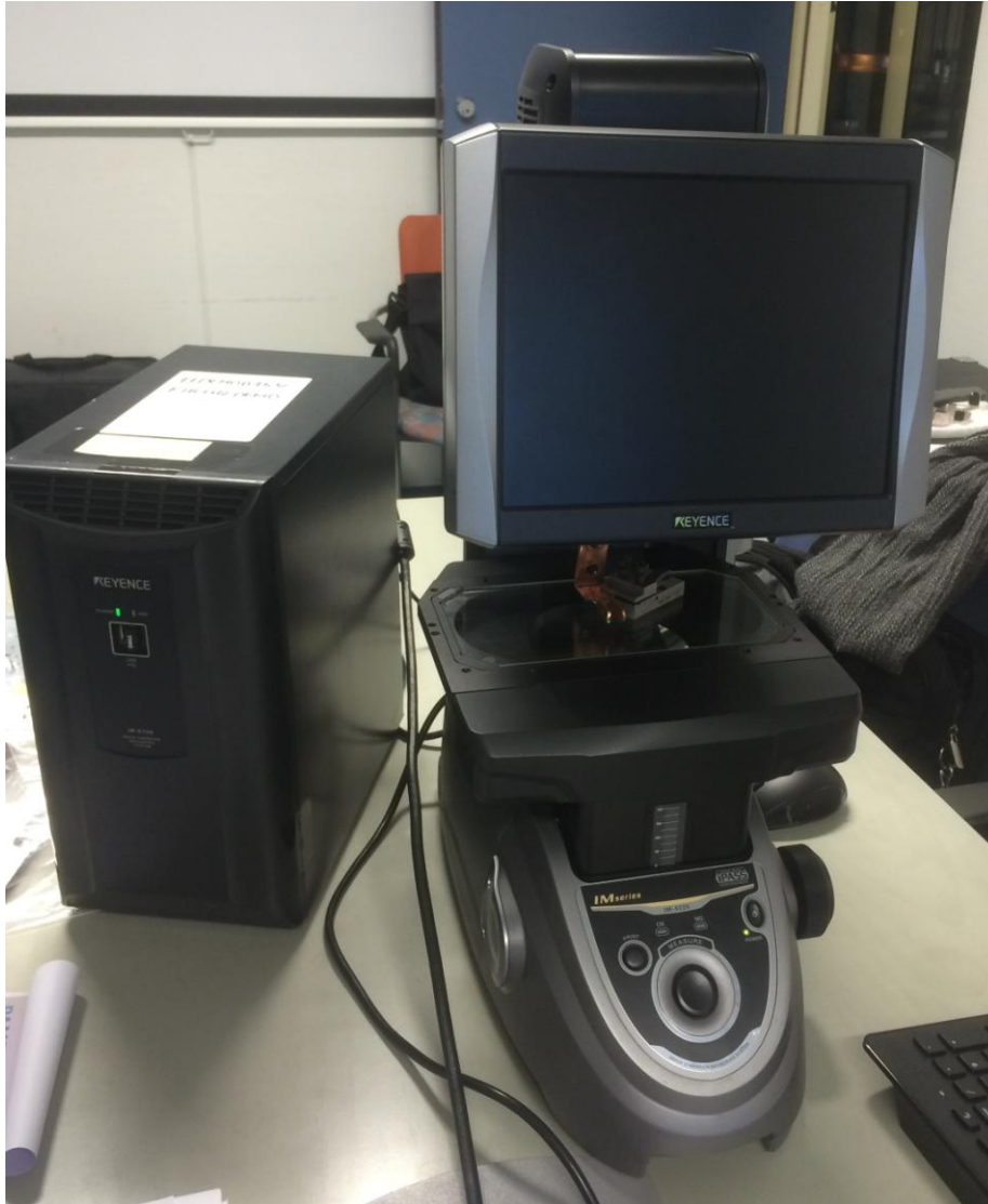
Kuva 21. Keyence IM-6225-mittalaite. Kuvassa näytekappale on kiinnitettynä jigiiin.
