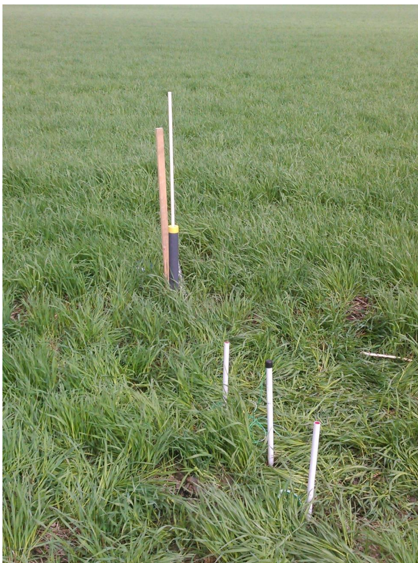
Kuva 3. Pohjaveden korkeuden ja maaperän kosteuden mittauspaikka. (Sakari Tamminen 2016)
