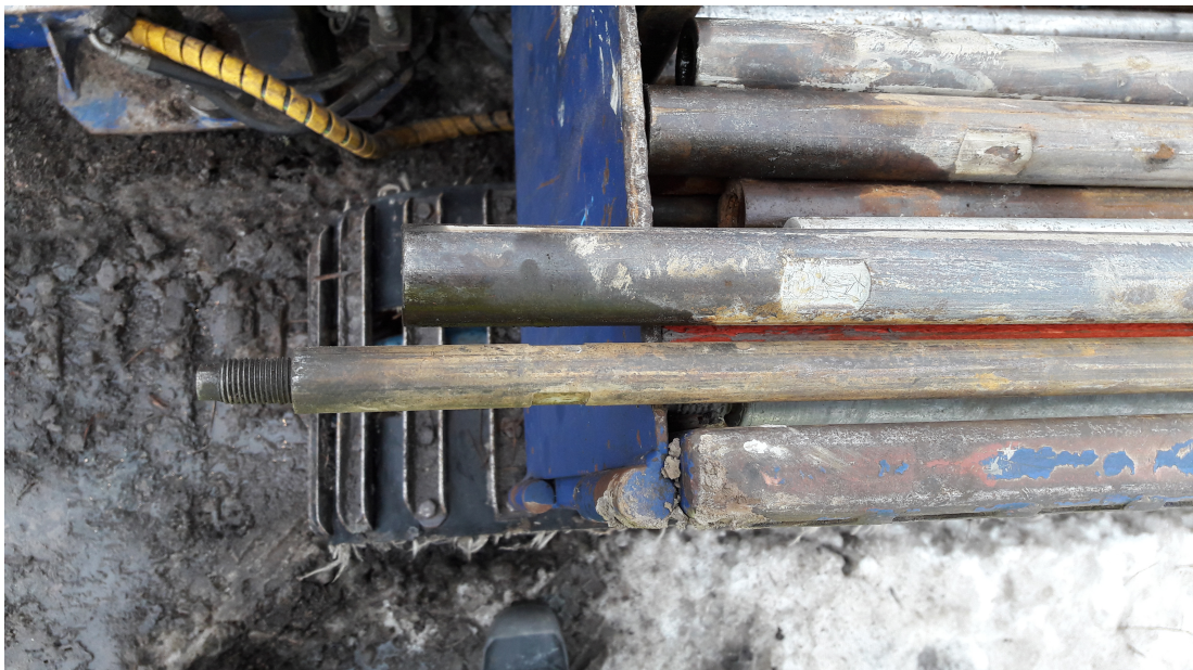
Kuva 6. Kairauksen edetessä käytettäviä jatkotankoja. 25 mm paksu soveltuu paino ja siipikairaukseen. Paksumpi 32 mm paksu tanko kestää puristinheijarikairauksen lyönnitkin taipumatta.
