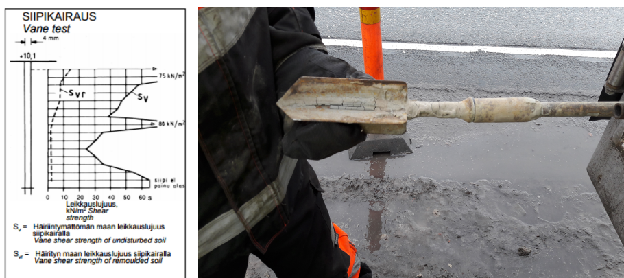
Kuva 7. Siipikaira ja siipikairauksen mittaustuloste (Suomen geoteknillisen yhdistyksen www-sivut 2005)
