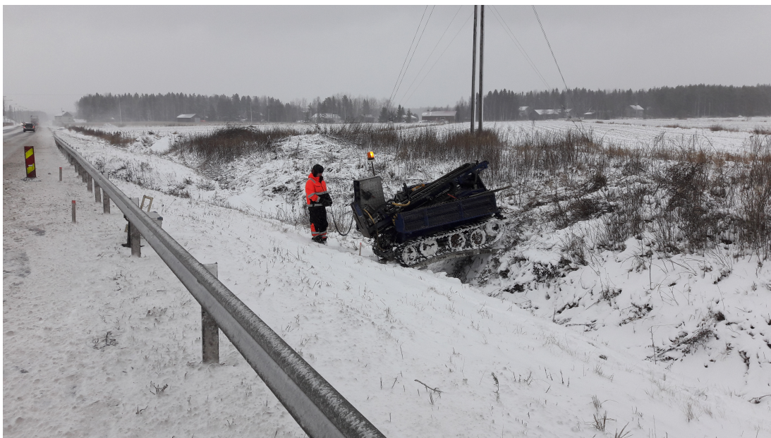
Kuva 3. Kairausvaunu KN1000 Jp special, jolla kairaukset ja maaperätutkimukset tehdään
