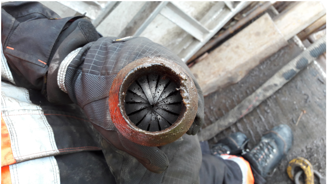
Kuva 5. Maanäytteenottolaite, joka kierretään maahan kairausvaunulla ja kun maaines on putken sisällä, liittimet sulkeutuvat ettei näyte putoa putkesta pois.
