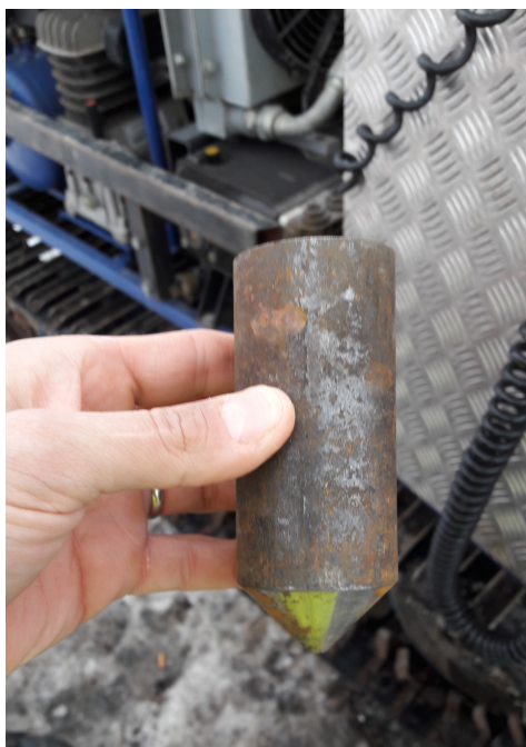
Kuva 11. Puristeheijarikairauksessa käytettävän terän ontto suoja, joka suojaa terää kun punttia pudotetaan muuhun kuin saviseen maaperään. Kairauksen päätyttyä suoja jää kairaussyvyteen.
