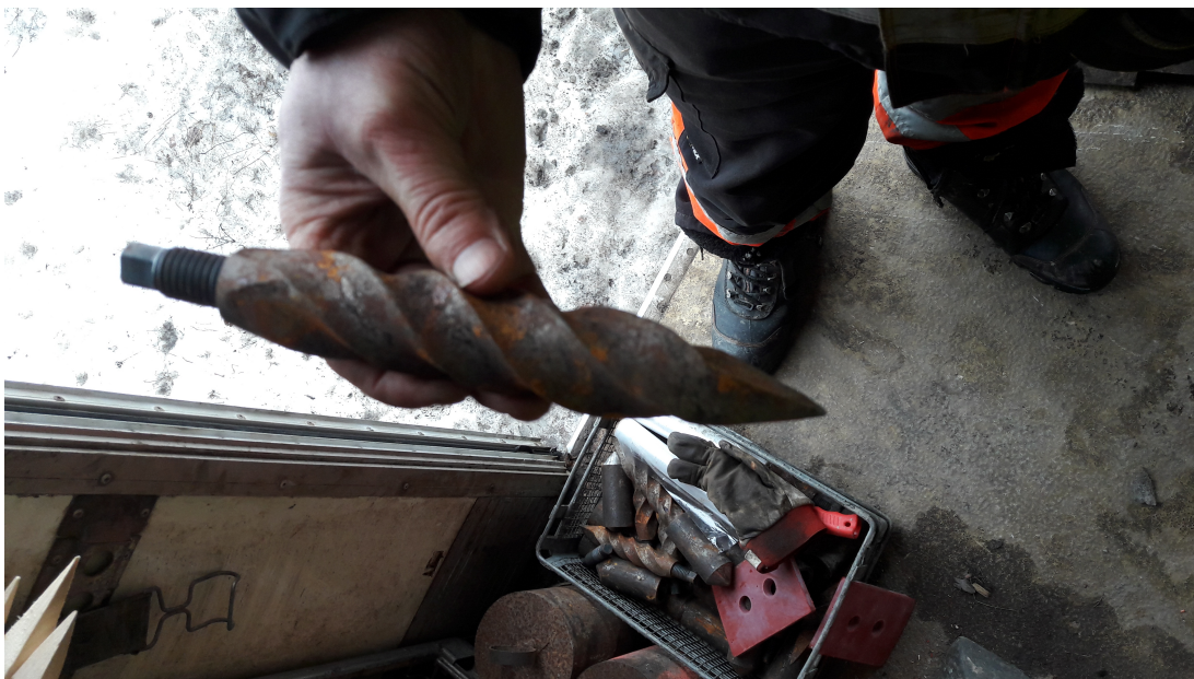
Kuva 10. Puristeheijarikairauksen terä. Samaa terää käytetään myös painokairauksessa
