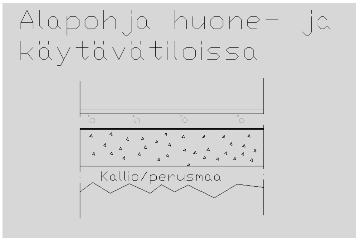
Kuvio 13. Leikkaus huone- ja käytävätilojen alaohjarakenteesta (mukaillen Pajarinen 1968)
