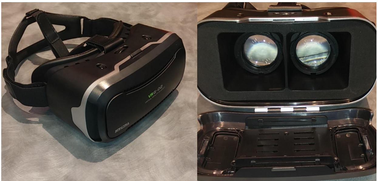
Kuvio 1. Kuvissa Spectra Optics G-02 3D -virtuaalitodellisuuslasit. Vasemmalla näkyy nykyai- kaisten virtuaalitodellisuuslasien yleinen muoto: hihnat, jotka tuetaan päähän ja virtu- aalitodellisuuslasien etuosa. Oikealla olevassa kuvassa näkyy virtuaalitodellisuusla- sien etuosa edestä avattuna. Älypuhelin sijoitetaan pöydällä makaavaan pidikkeeseen.
