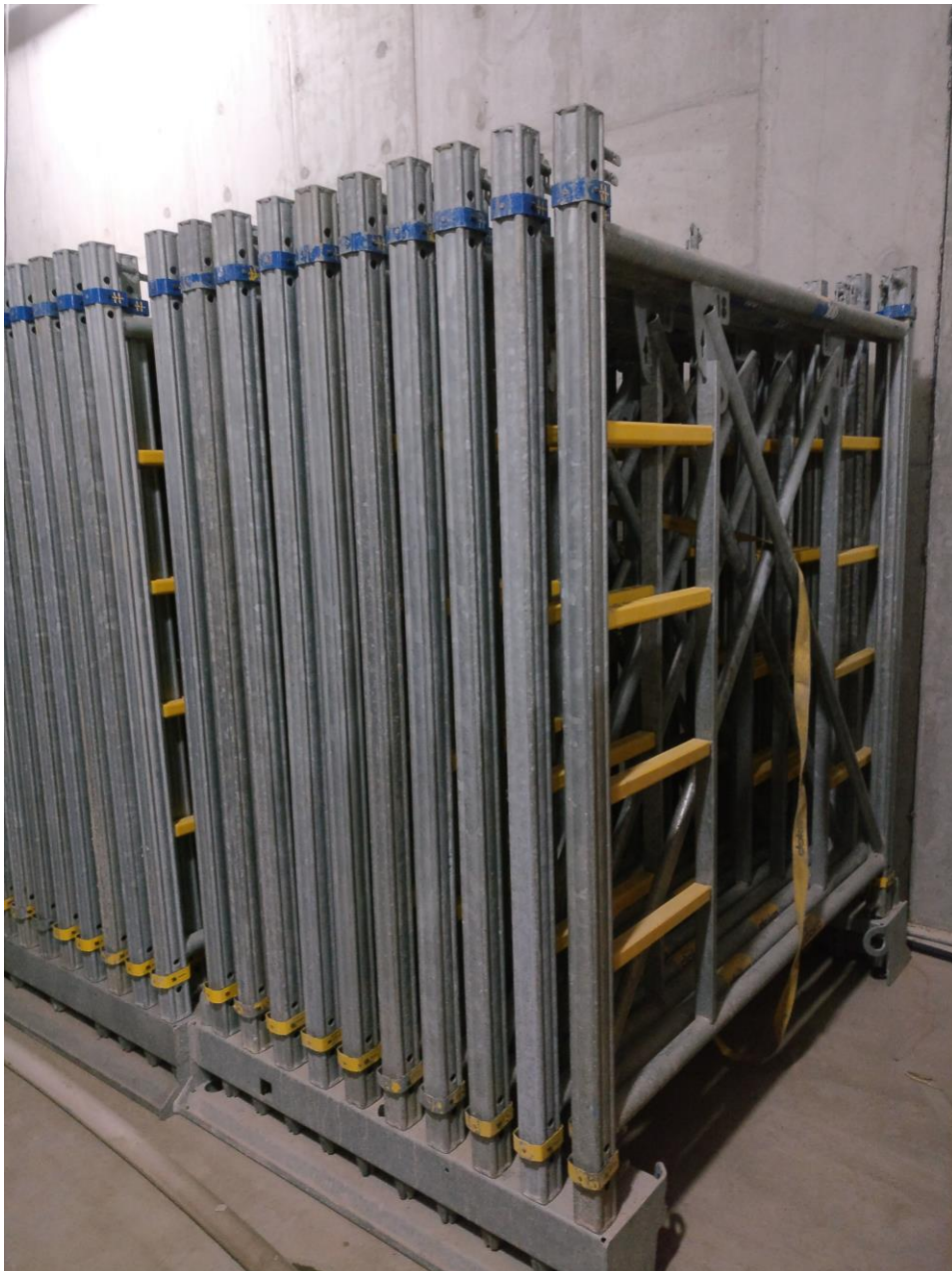
KUVA 4. Doka Staxo 1800mm korkeita runkoja säilytyksessä
