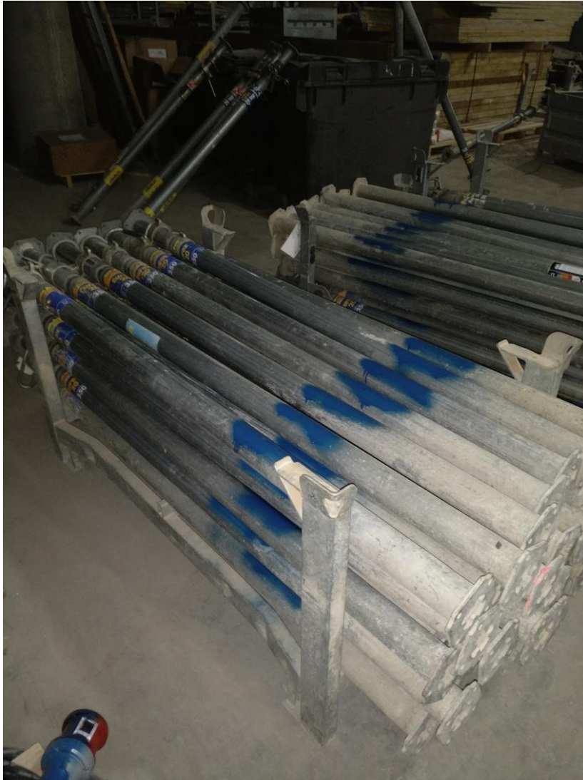
KUVA 15. 3500mm korkeuteen yltäviä holvitukia varastoituna
