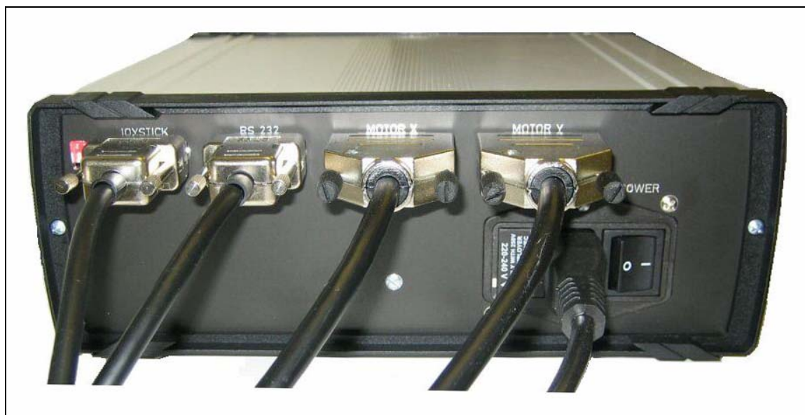
Kuva 7. Ohjausyksikön takapaneeli ja liitännät
