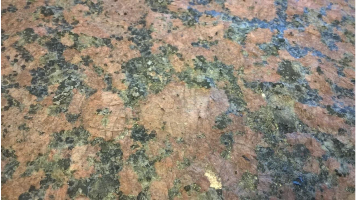
Kuva 1 Poltettu pinta (Kuva: Jussi Eskelinen, Ylamma Massive Granite Oy)
