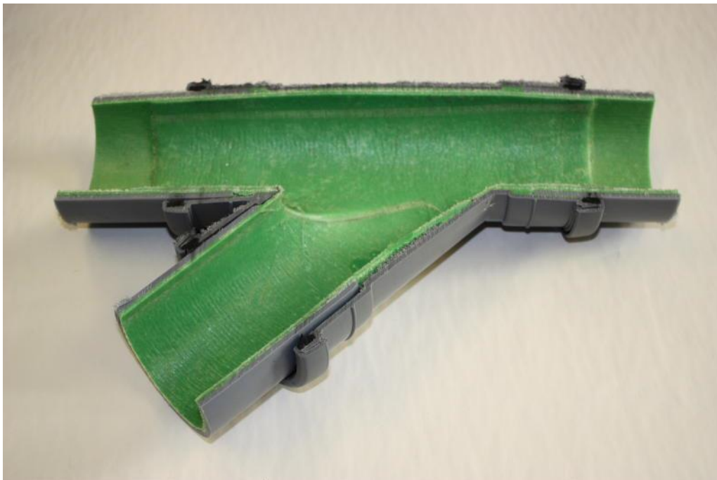
Kuva 4. Erään sukitukseen erikoistuneen liikkeen esittelykuva sukitetusta viemäristä [14]
