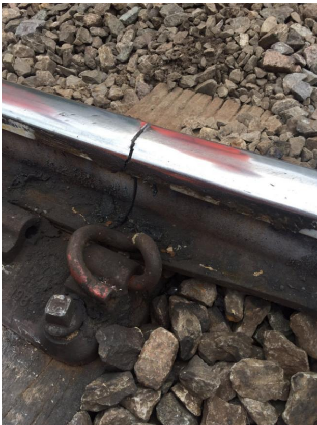
KUVA 3. Tyypillinen kiskon katkeama (Bucks free press 2016)
