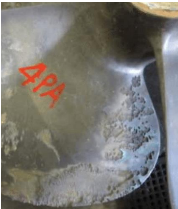
KUVA 4. Kavitaation aiheuttamia jälkiä potkurin siivessä (13)
