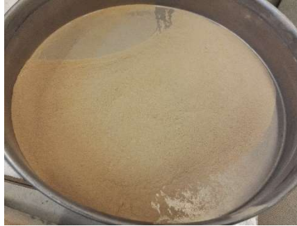
KUVAT 1 ja 2: Kuivaseulontaan käytetty laite ja 0,125 mm:n seulan läpäissyt kiviaines.
