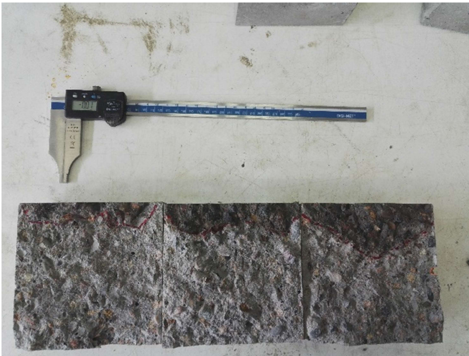
KUVA 11: Paineellisen veden tunkeutumat ja mittalaite.
