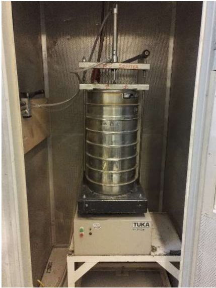
KUVAT 1 ja 2: Kuivaseulontaan käytetty laite ja 0,125 mm:n seulan läpäissyt kiviaines.
