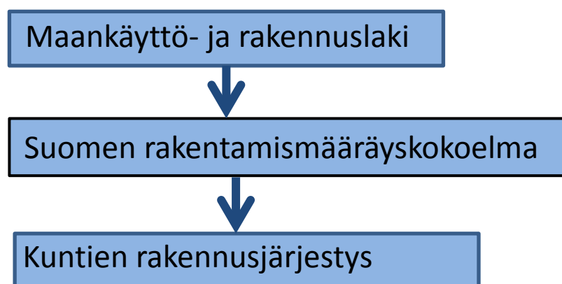
Kuva 7. Rakennuslupaa määrittävät lait, asetukset ja ohjeet
