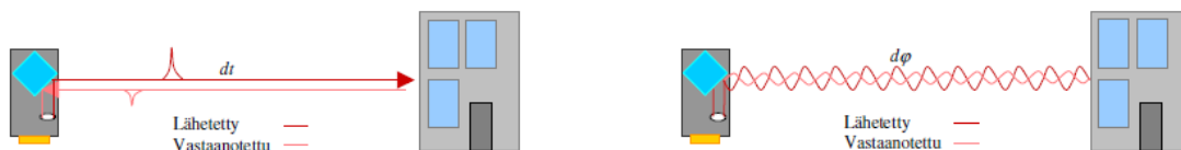
KUVA 4 Aikaero- ja vaihe-erolasereiden toimintaperiaatteet (6, s.7)
